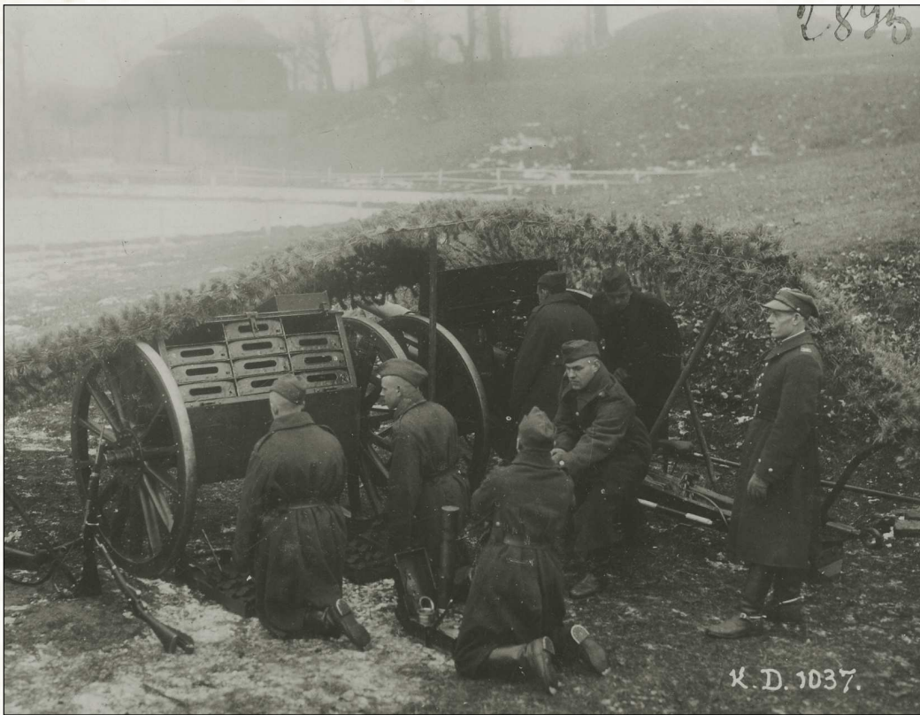
Zamaskowane stanowisko artyleryjskie armaty wz. 1902/26 artylerii piechoty. Po lewej stronie widoczny jaszcz do przewożenia amunicji.
