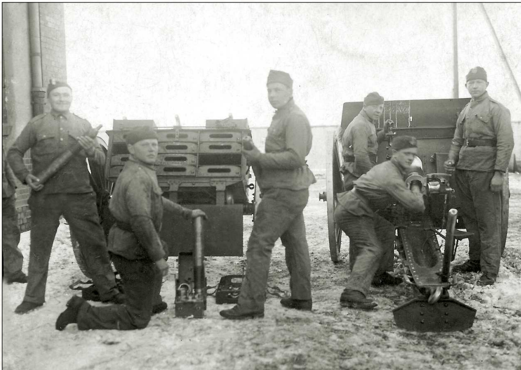
Działaczyny przy armacie wz. 1902/26. Żołnierz z obsługi jaszczka umieścić nabój do armaty w nastawnicy, celem ustawienia długości lotu pocisku ze szrapnelami. Ładowniczy przy dziale wprowadza naboju do komory naboju, zamkowy trzyma rączkę otwierania zamka armaty. Fot. ze zbiorów Jacka Habra
